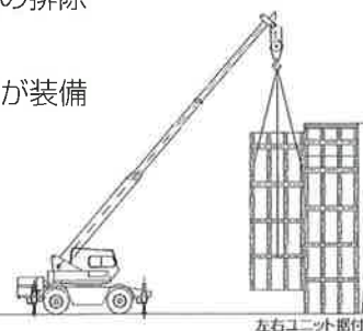
左右ユニット据付
