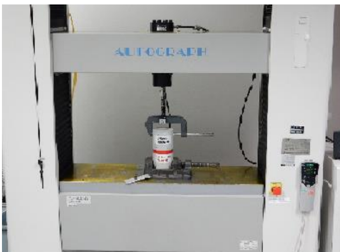
養生期間 72 時間の基台と試験体 \phi 100 \times 100 mm
